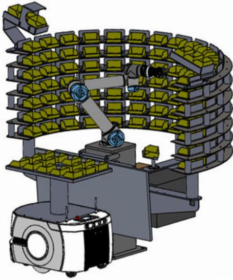
La structure du magasin demi-cylindrique comporte 105 emplacements de stockage répartis sur 7 étages. Ces emplacements accueillent des bacs en plastique vides ou remplis de pièces nécessaires aux autres plateformes.
