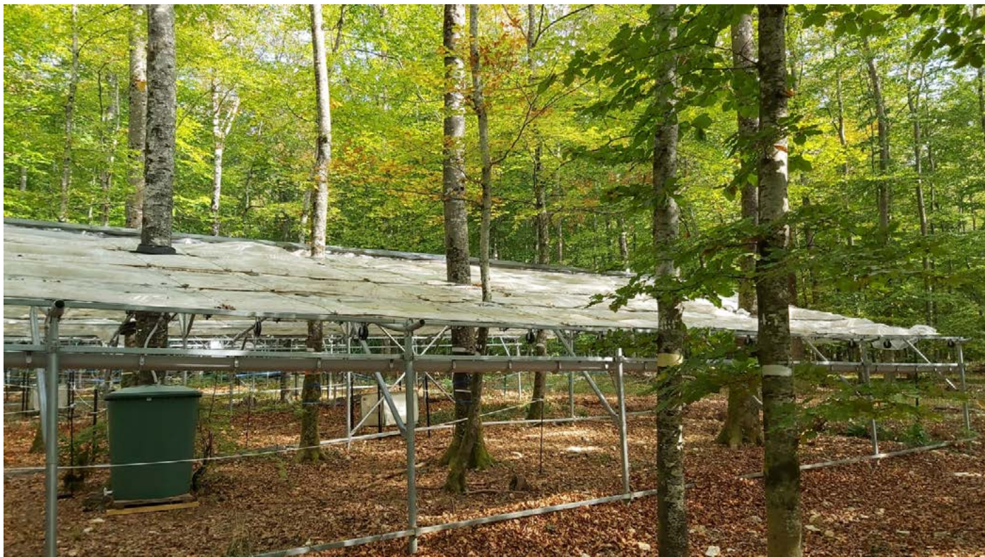
Vue d'ensemble du dispositif sécheresse en position fermée lors de l'inauguration en septembre 2020
