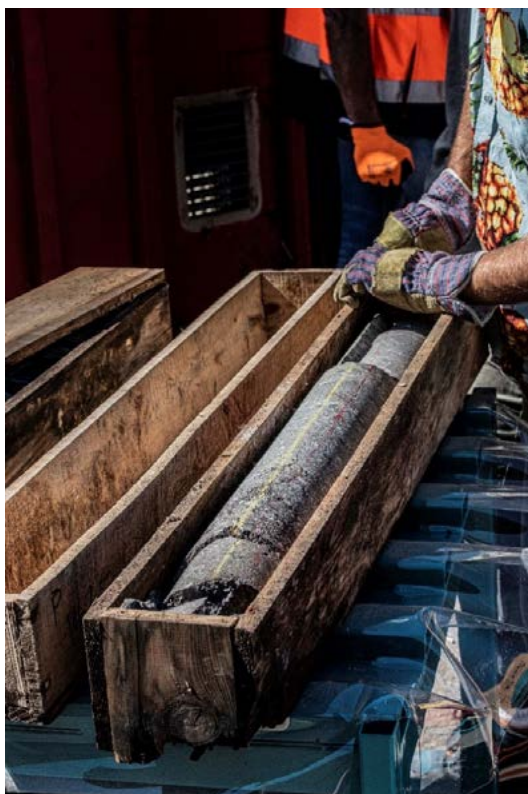
Transvasement d'une carotte de sa boîte endommagée vers une boîte en bon état
