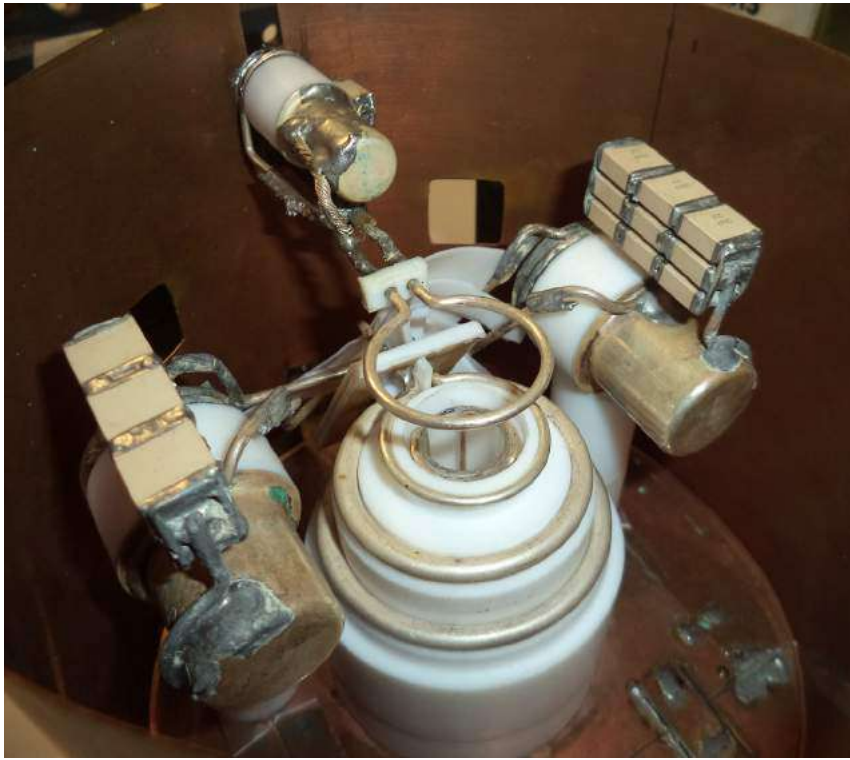
Bobine radiofréquence pour la spectroscopie RMN dans les matériaux à temps de relaxation courts
