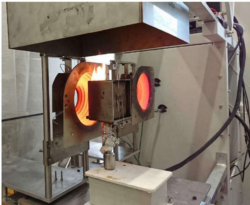
Essai sur l'inflammabilité du bois sous des conditions de flux thermiques donnés
