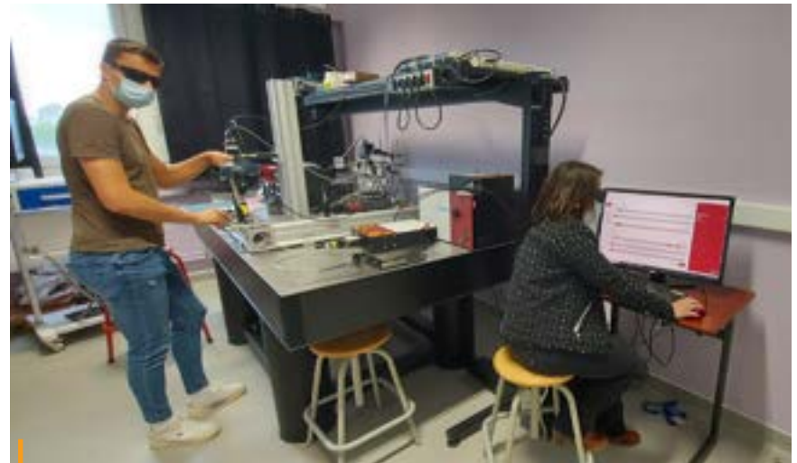
Banc à double sphères intégrantes et laser supercontinuum pour la mesure des coefficients optiques de tissus biologiques ex vivo
